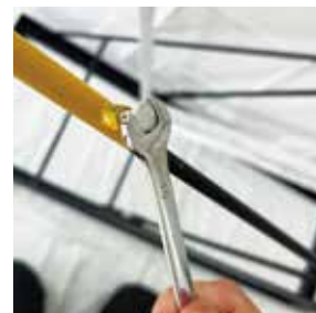
②アタッチメント4か所のボルトを調整します。
