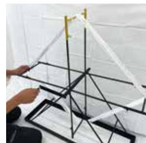
④再度、黄アタッチメントに結び巻取開始(一回転で1本の計算です)
